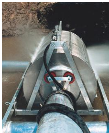
FILTRO ALIMENTATO PER GRAVITA'
