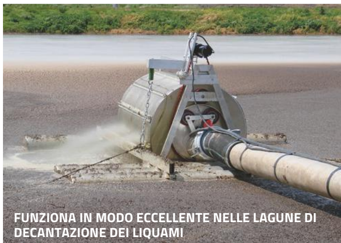
FILTRO CON GRUPPO DI POMPAGGIO VERTICALE FLOTTANTE
